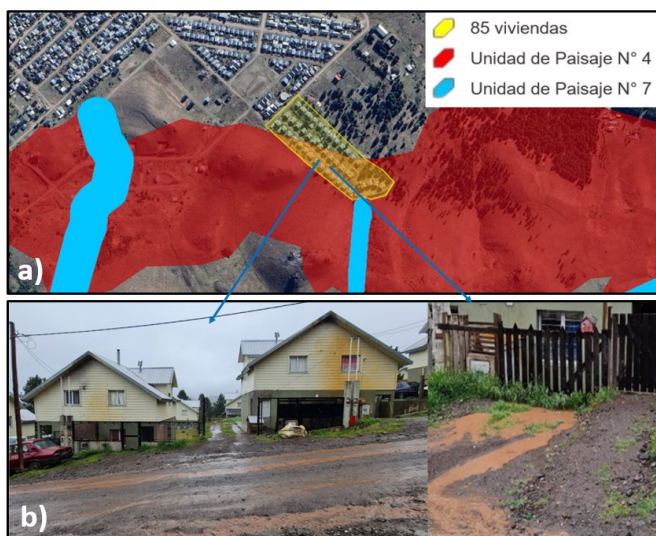
Figura 8. a) Localización del barrio “85 viviendas” en la unidad de paisaje (UP) 4 (Tabla 1, 4) y en la salida de la escorrentía de un cauce de la UP 7 (Tabla 1, 7). Fuente: Elaboración propia en base a imágenes de Google Earth. b) Inundaciones y afectación producto de intensas precipitaciones. Fuente: fotografías obtenidas en Salida al campo, nov. 2023.
