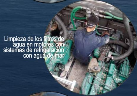
Limpieza de los filtros de agua en motores con sistemas de refrigeración con agua de mar
