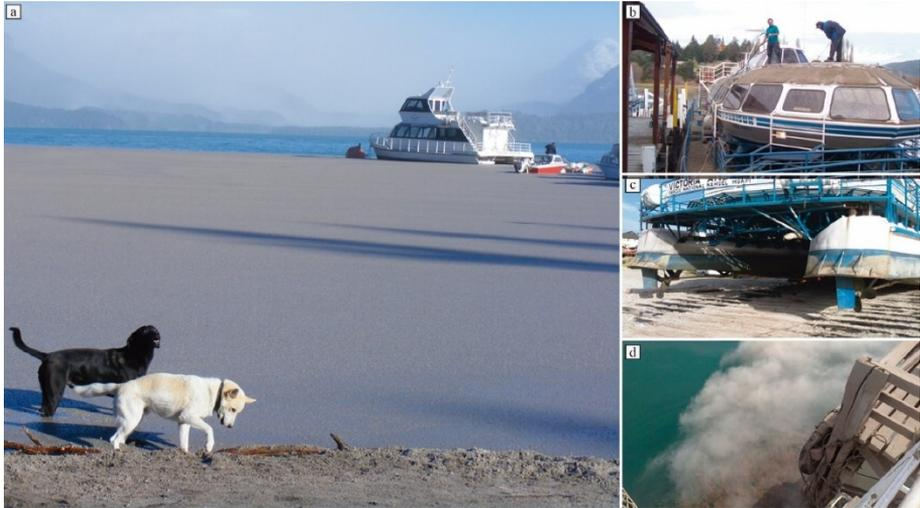
**Figura 2.** Efectos de la ceniza volcánica en embarcaciones y sitios portuarios: (a) formación de *pumice rafts* en Mlle. La Flecha (Neuquén); (b) limpieza de buques de pasajeros en Pto. Pañuelo (Río Negro); (c) inspección en seco de los sistemas de transmisión y propulsión del Catamarán Victoria Andina (Río Negro); y (d) removilización de ceniza volcánica por acción de las hélices del Catamarán José Julián en Pto. Canoa (Neuquén).
