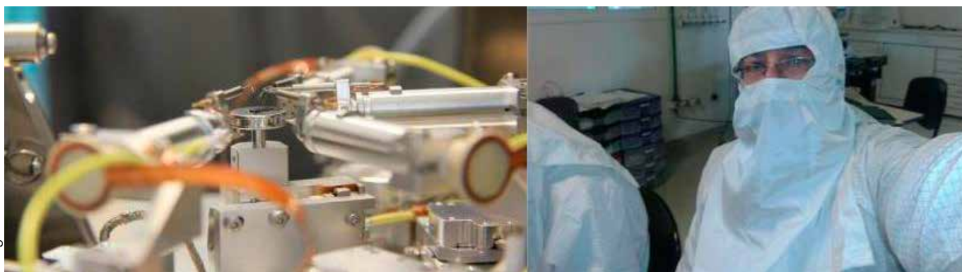
44 Figura 2. A la izquierda, detalle de la platina del nanomanipulador que va en la cámara del microscopio electrónico de barrido, donde están sus actuadores piezoeléctricos y las cuatro puntas de prueba. A la derecha, en la Sala limpia del INN-CAB, operando el Microscopio SEM y su nanomanipulador.
