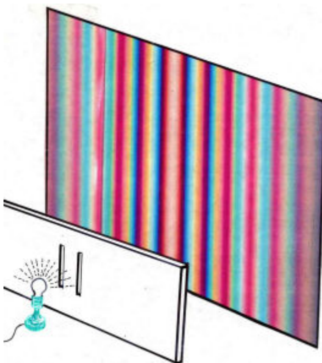
Fig. 6. Difracción de la luz: cada color (longitud de onda) de la luz blanca atraviesa las dos rendijas y al arribar a la pantalla la intensidad del color se potencia o cancela según sea la diferencia de caminos seguidos desde las rendijas.
