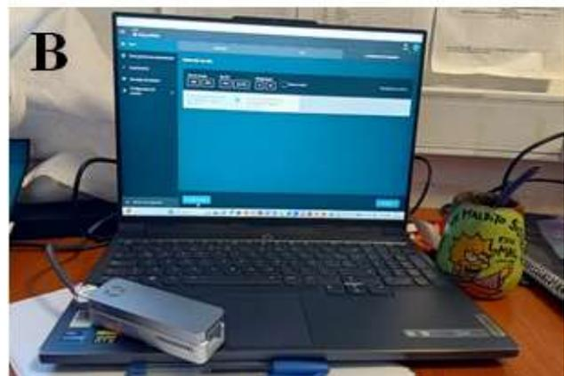
**Figura 2.** Secuenciación en IBAC (CONICET-UNCo). A. Cargando una muestra para secuenciación masiva en el minidispositivo de Oxford Nanopore Tech (MinION o coloquialmente “minion”). B: El dispositivo de secuenciación masiva conectado vía USB a notebook, donde puede seguirse el proceso en tiempo real.
